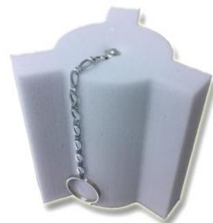
Nuestros cartuchos de aislamiento acústico Air-In son muy fáciles de instalar y de mantener limpios. El cartucho de aislamiento acústico Air-In se fija a la válvula mediante el anillo situado en el extremo de la cadena y se introduce en el tubo. Ponemos a su disposición cartuchos Air-In CAA para los tubos de entrada y salida de aire existentes, de 100, 125 y 160 mm de diámetro.
